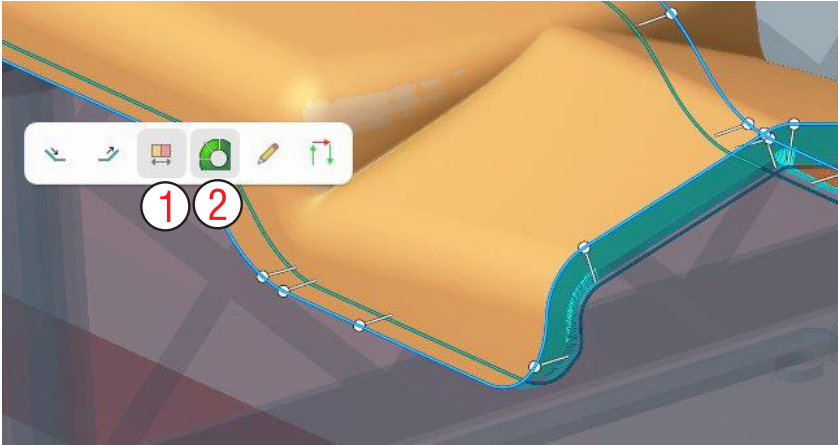
Рис. 18-7. Дополнительное меню операции 6D контур.
