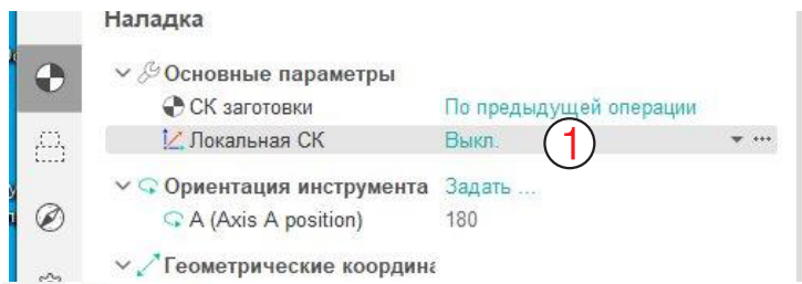
Рис. 8-5. Настройки операции Обработка отверстий для 3+2 осевой обработки.
