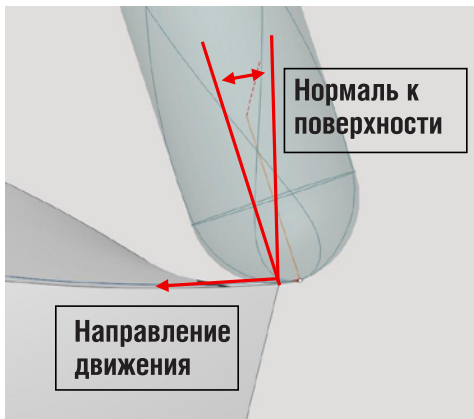
Рис. 13-7. Угол опережения в ориентации инструмента.
