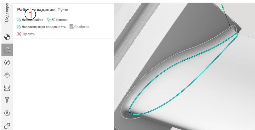
Рис. 13-26. Рабочее задание операции 6D контур для обработки радиуса скругления пера и хвостовика.
