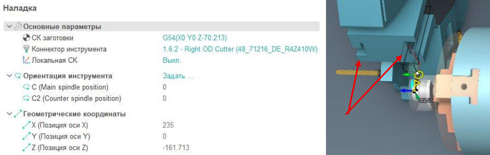
Рис. 11-19. Смена коннектора инструмента для работы в контршпинделе.
