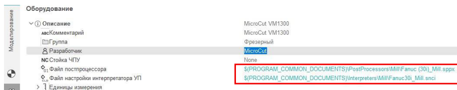
Рис. 9-8. Настройки интерпретатора для моделирования по УП.
